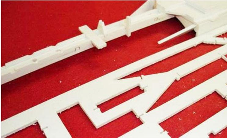
Die Pufferbohle wird montiert auf die Rahmenköpfe.
