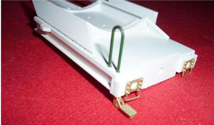
Weiter wird die Pufferbohle bestückt mit der Kupplungsmund, Bremsschlauch und Bremspodest.
