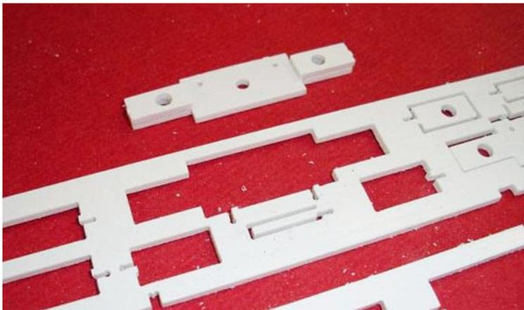
Unter den Hauptträger werden die Bremsgestange Führungen geklebt.
