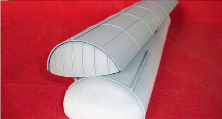
Nachdem das Unterteil mit einer orangen Streife besprüht ist (Ral 2000), wird das orangeteil abgeklebt mit Klebeband (3 M -6 mm) und bekommt dem Kessel der richtige Anstrich. (= für Wascosa French Army Blue.)
