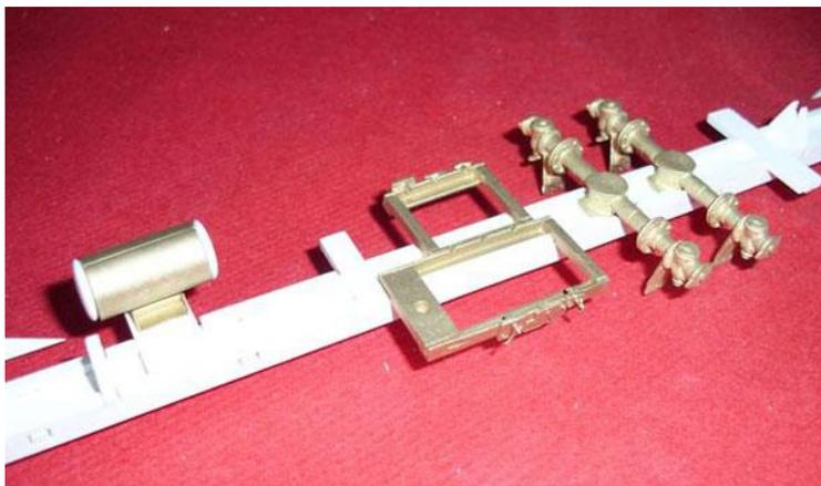
Dazu kommen noch der Bremszylinder mit den Bremshebeln und das Entlüftungsventil.
